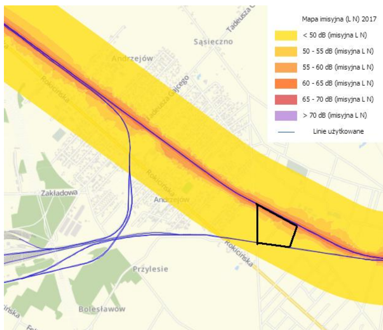
Mapa emisji hałasu (wskaźnik LDWN) z istniejących linii kolejowych na obszarze opracowania mpzp Źródło: http://mapa.plk-sa.pl/
